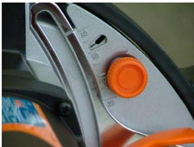
Затяните до отказа рукоятку. Защитный кожух размечен шагом от 0 до 60 мм, чтобы облегчить установку глубины реза.
