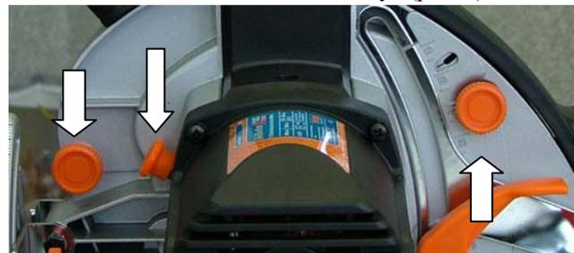
Отвинтите болт, крепящий диск, насадным ключом. Используйте стопор диска (рис 2)
